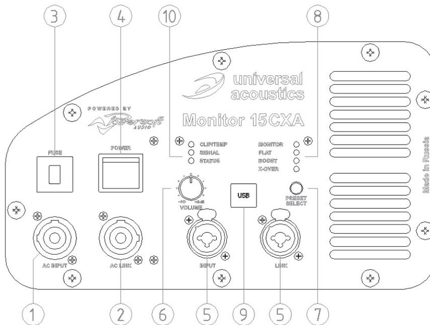
Поз.1 - **AC INPUT** – разъем для подключения сетевого кабеля ~220/230В, 50/60Гц.
