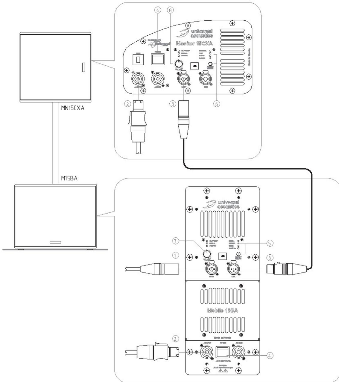
Пресет **X-OVER** - оптимизирован для работы с активной низкочастотной акустической системой **Mobile 15BA**.
